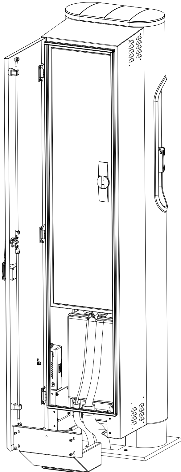
Abbildung 8: Aufbau Technagon TEP4 HAK außen
